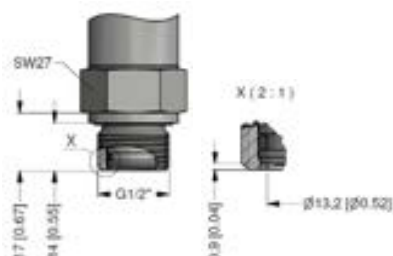
G1/2" flush DIN 3852 ( p_N \leq 40 bar)
